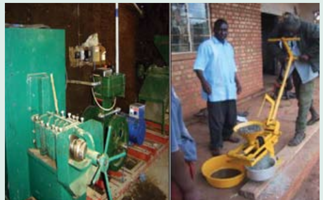
Mashine za kukamua mafuta kutoka kwenye mbegu za jatropa.
